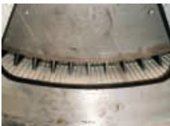
Liner cerámico con palas de carburo
