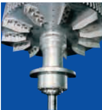
Rotor del CM1500 con palas de ventilación
