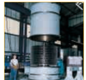
Aflojar la carcasa del molino
