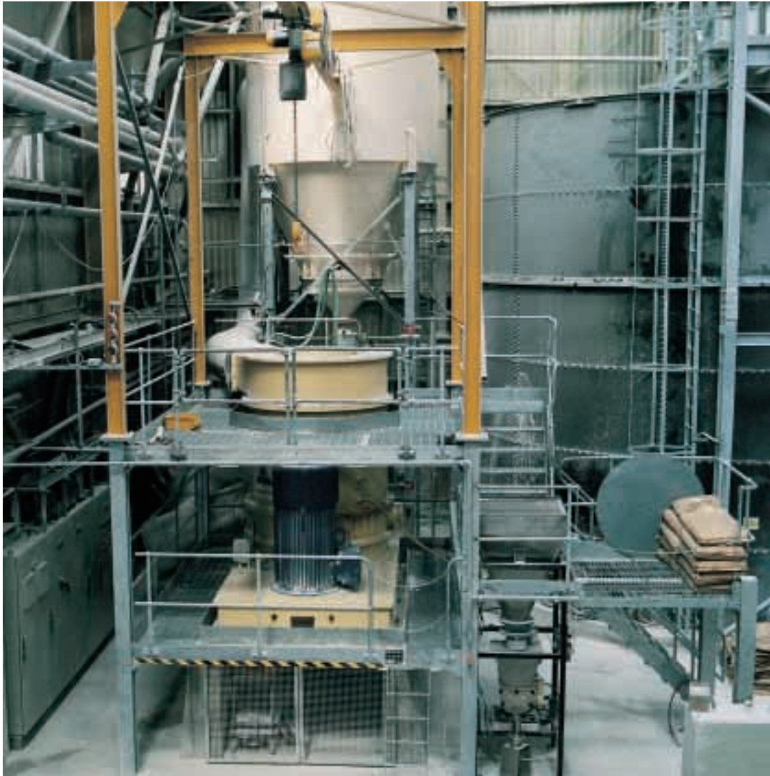
Planta CMI500 para el secado y recubrimiento de Carbonato Cálcico
